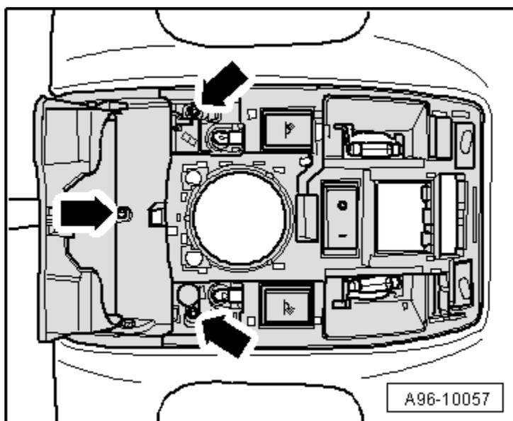
Отвернуть (при наличии) болт -стрелка- в проеме потолка для переднего плафона освещения салона/фонаря для чтения.
