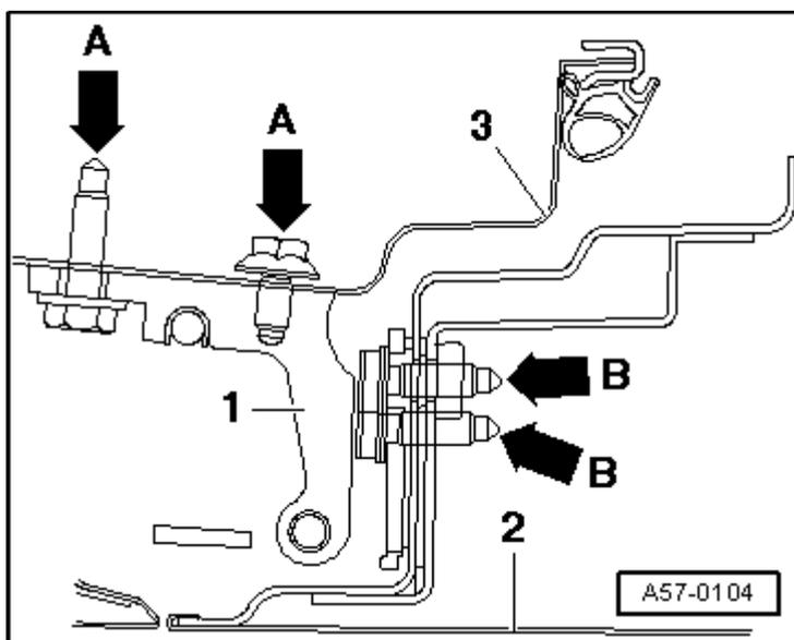
**Регулировка с помощью скобы замка**
