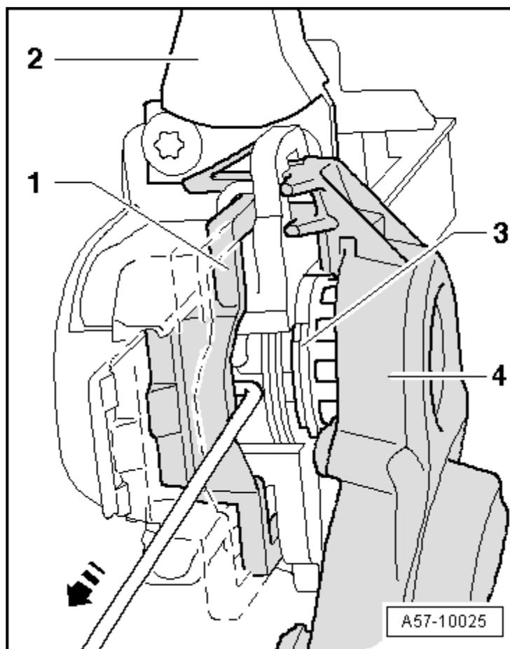
Отжать фиксатор -2- в направлении стрелки к центру автомобиля, например с помощью отвертки.
