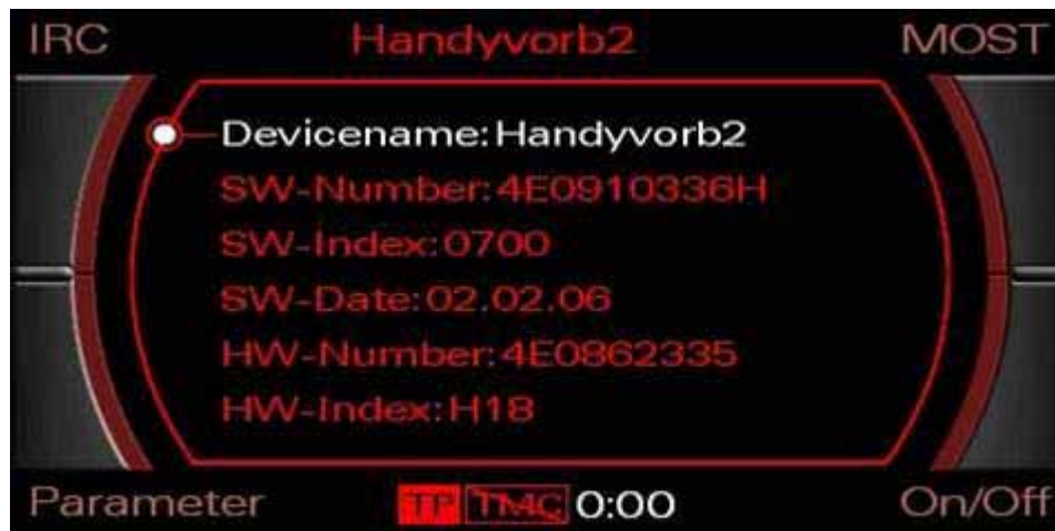
Рис. 15: Проверка индекса аппаратного обеспечения (HW)
