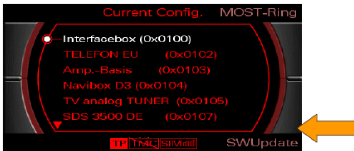
Рис. 2: Выбор обновления ПО управляющей кнопкой справа внизу
